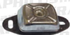
Nosač motora nosivosti max. 280kg, vijak 16mm, visina 50mm, širina 65mm, dužina od vijka do vijka za fiksiranje 137-148 mm
